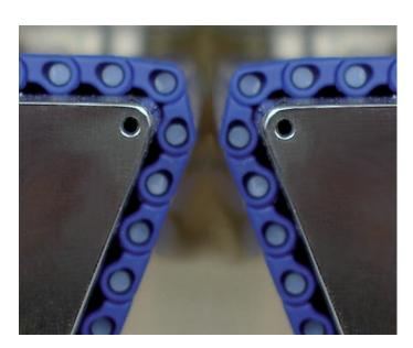
Das Micropitch Modulband ist ein einzigartiges Band für besonders enge Übergaben, die einen stabilen und sicheren Transport für empfindliche und schmale Produkte gewährleisten.
